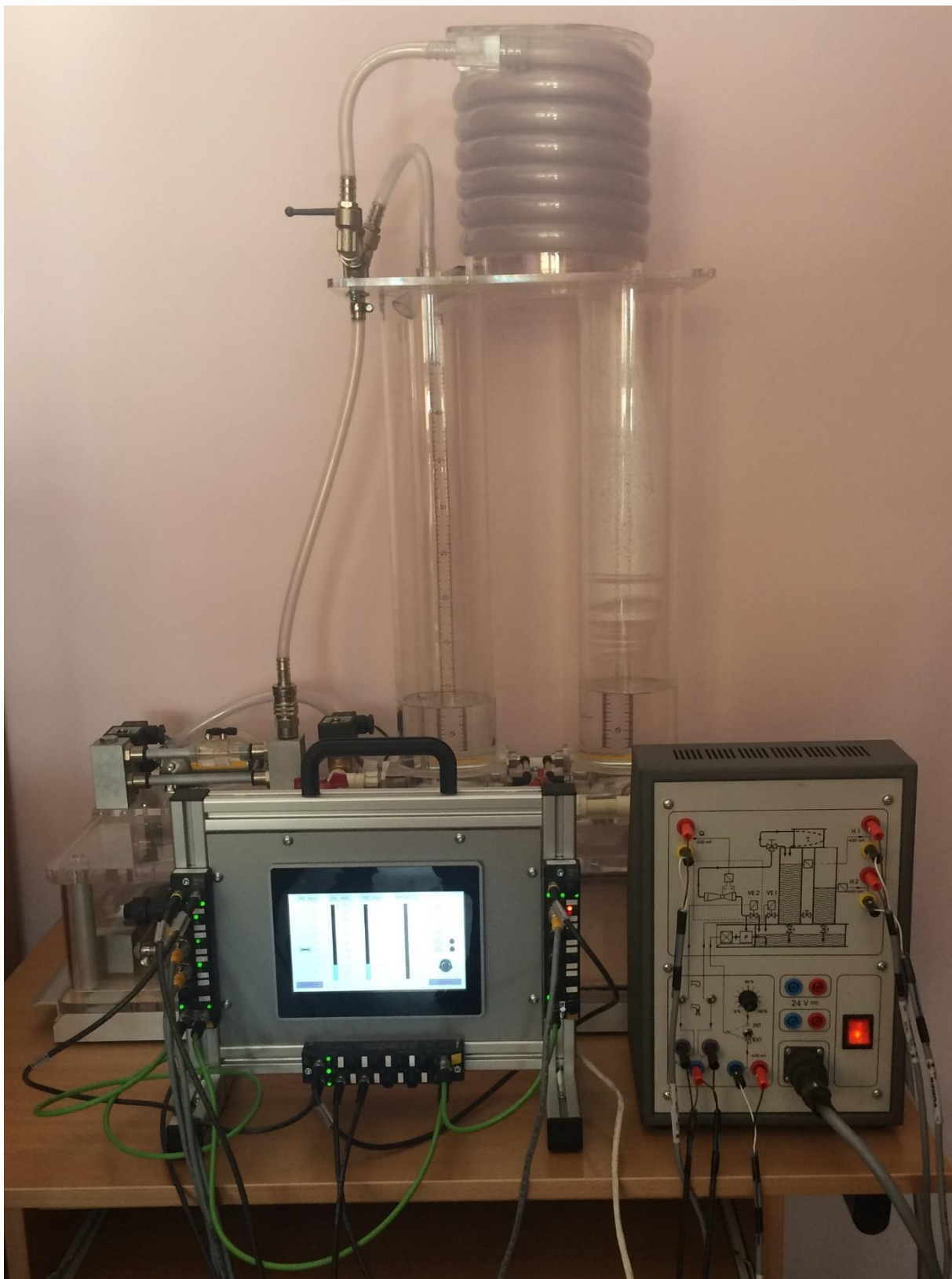
Rys. 2. Stanowisko laboratoryjne do regulacji poziomu cieczy
