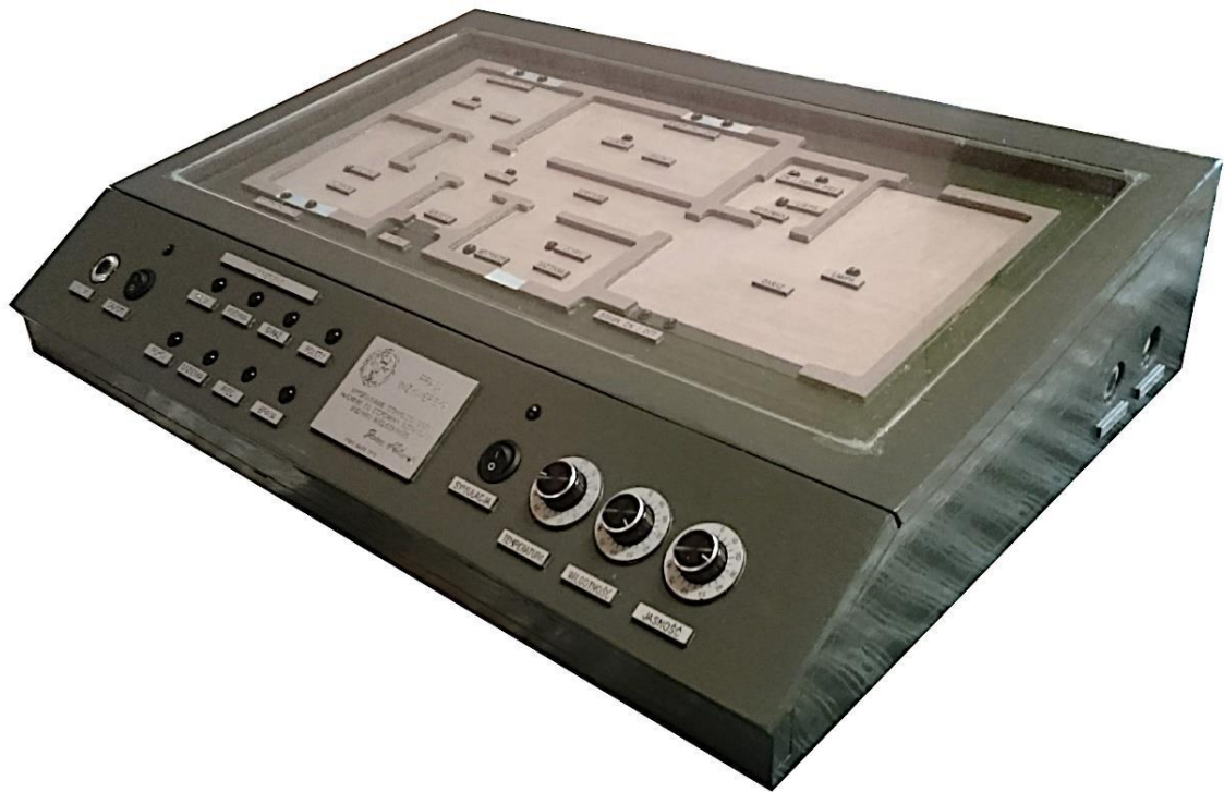
Rys. 1. Symulator sterowania domu jednorodzinnego
