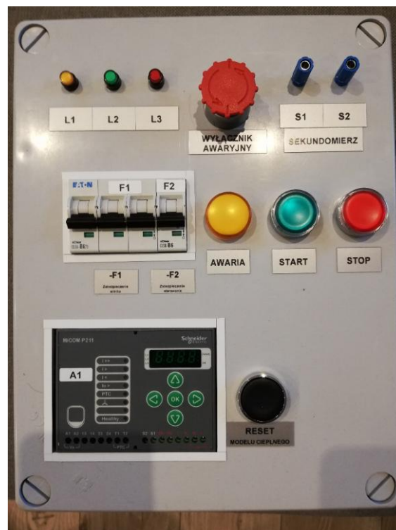
Rys. 1. Panel czołowy stanowiska dydaktycznego
