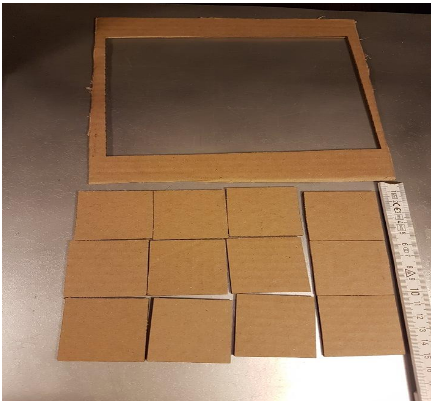
Rys. 2. Wynik testu cięcia kartonu ploterem
