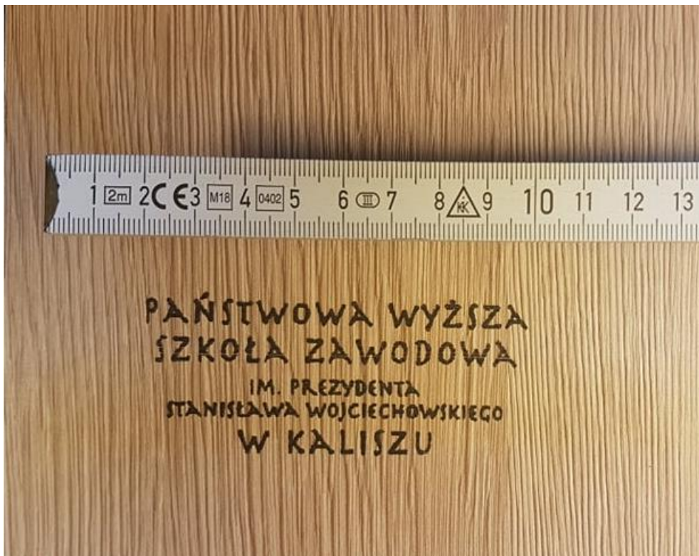
Rys.2. Grawerunek wykonany ploterem laserowym CNC
