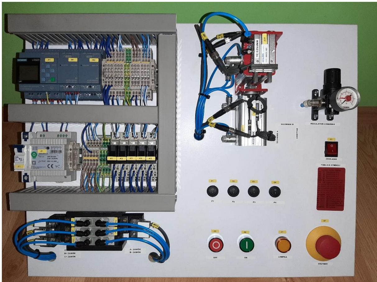
Rys. 1. Stanowisko dydaktyczne do nauki programowania sterownika PLC
