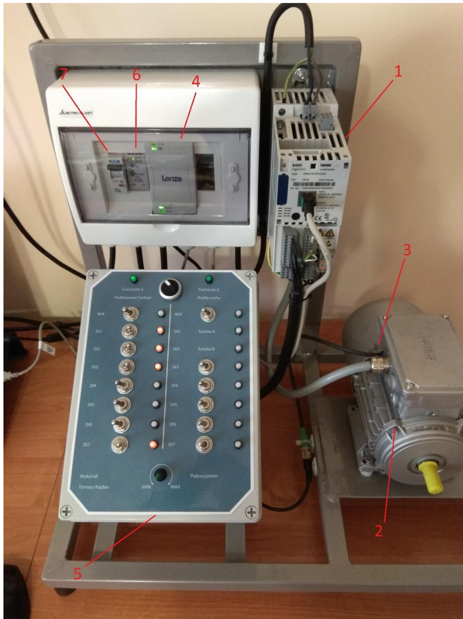
Rys. 1. Stanowisko laboratoryjne: 1- Przełącznik częstotliwości, 2- Silnik napędowy, 3- Enkoder inkrementalny, 4- Moduł diagnostyczny, 5- Panel sterujący, 6- Zasilacz 24V DC, 7- Wyłącznik nadprądowy
