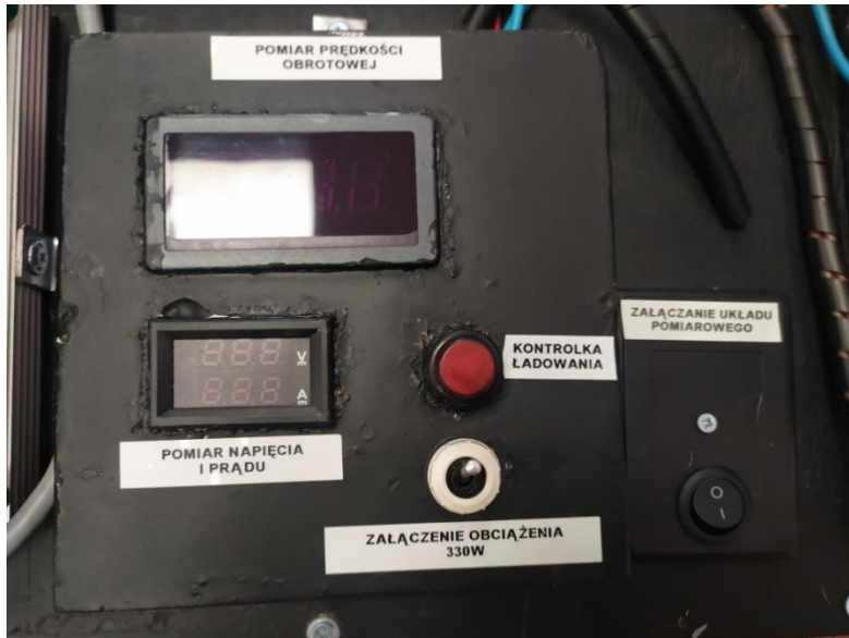
Rys.2. Układ pomiarowy z kontrolką ładowania
