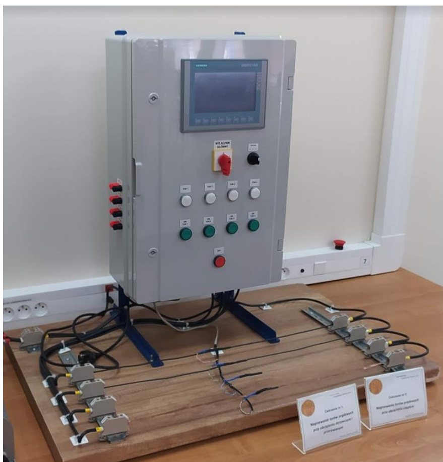
Rys. 4. Widok stanowiska do wizualizacji nagrzewania się torów prądowych
